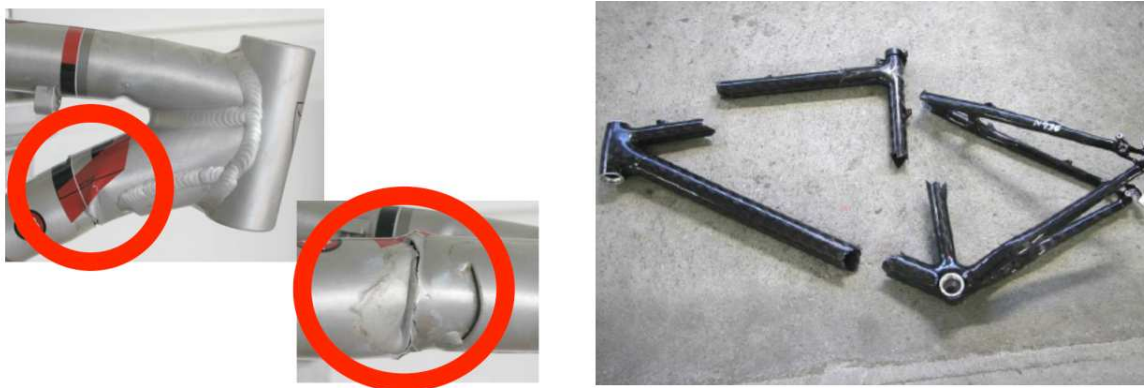
Abb. 4: Kraftabsorption und Bruch bei Aluminium Rahmen und CFK Rahmen [4]
