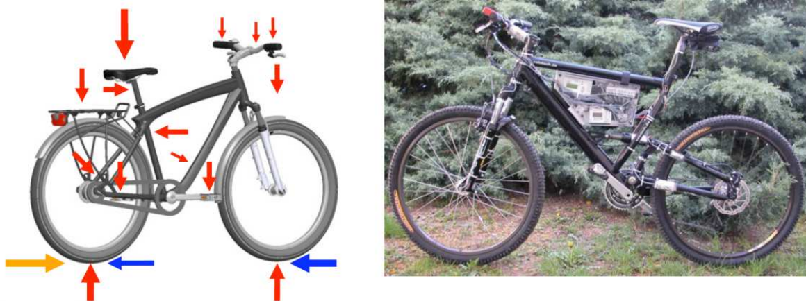
Abb. 3: Kraftangriffspunkte an einem Fahrrad und ihre experimentelle Erfassung [3]
